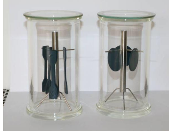
Bild 2: Einlagerung der Probekörper im Prüfgefäß
