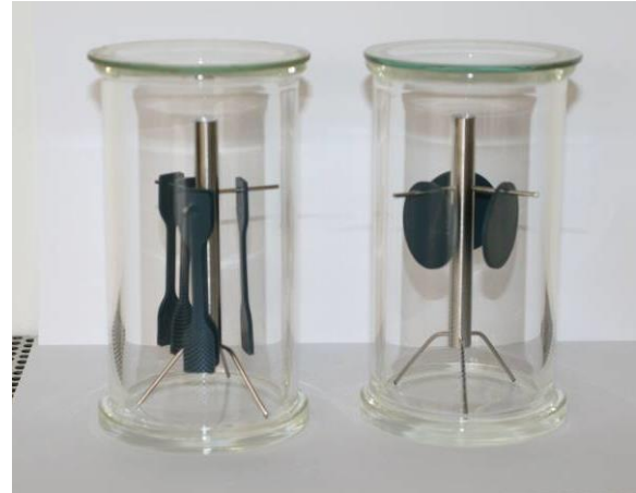
Bild 2: Einlagerung der Probekörper im Prüfgefäß
